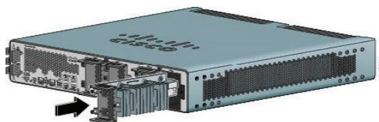
Установка в маршрутизатор модуля GRWIC-D-TS-2S-8PC
